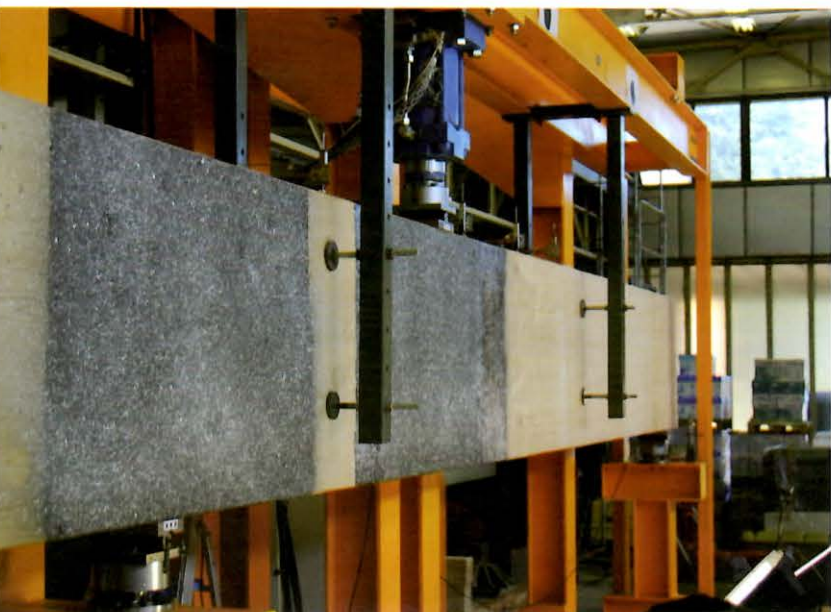
▲ Portique pour des essais mécaniques à l'échelle 1 au laboratoire du centre universitaire de génie civil d'Égletons.
